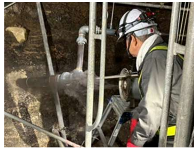
石炭に着火直後の黒煙発生状況
