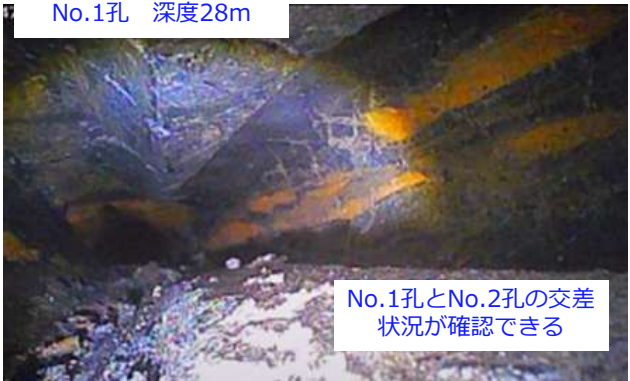
水抜き後の同軸孔と補助生産孔の交差部 水位は30m付近まで後退, 圧縮空気により加圧することで壁面の水滴消失
