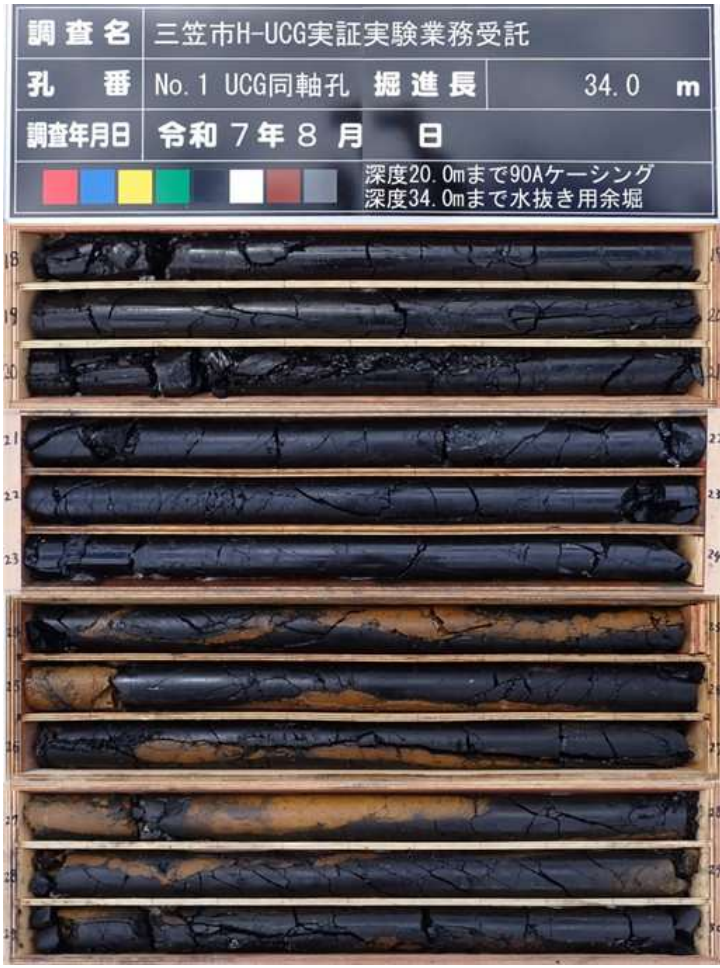
同軸孔の掘削コア 18m～30m
