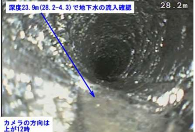
掘削直後の同軸孔内の水の状況 23m付近より湧水（左），25mより奥部は水没
