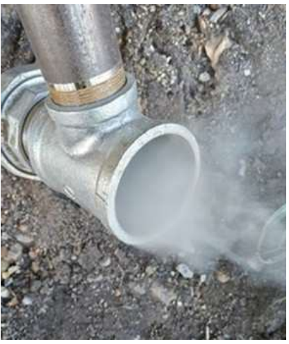
1回目の着火では水蒸気のみが発生し石炭への着火には至らず
