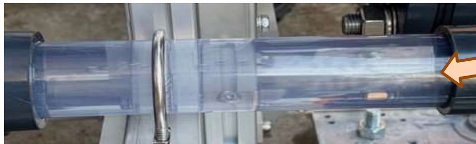
CO 2 の泡が消えマイクロバブル化された状態
