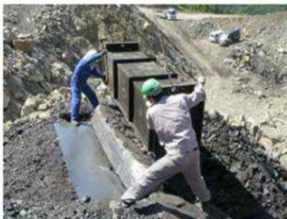
写真 2-4 切出した石炭に鋼製容器を被せる
