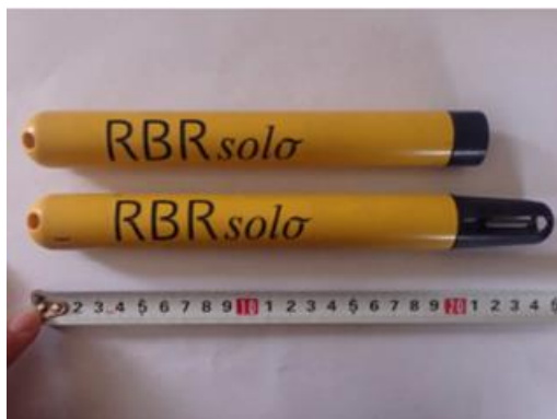
孔底に設置した圧力センサ/温度センサ
