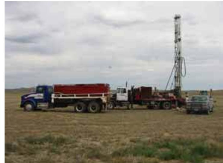
通常、掘削機器はモバイルタイプのロータリー型が使われる。
